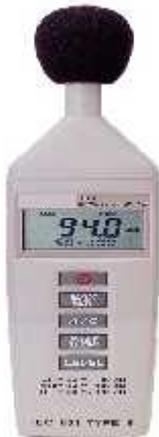
Gambar di atas adalah Sound Level Meter (SLM)
